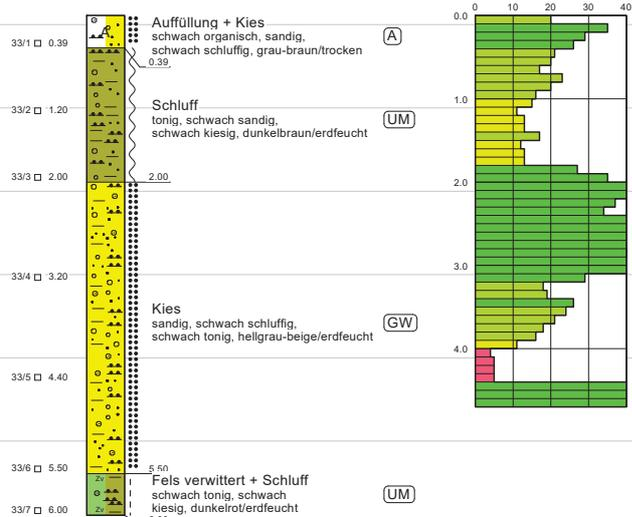
Bohrung bei 3,07 m u. GOK zugewallen!
