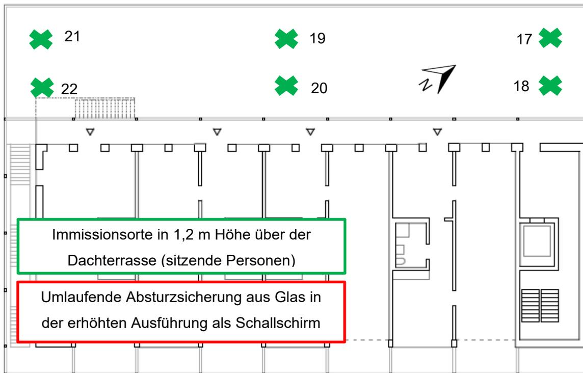
**Abbildung 14:** Grundrissdarstellung des zweiten OG des Gebäude 4 mit Draufsicht auf die Dachterrasse [13]
